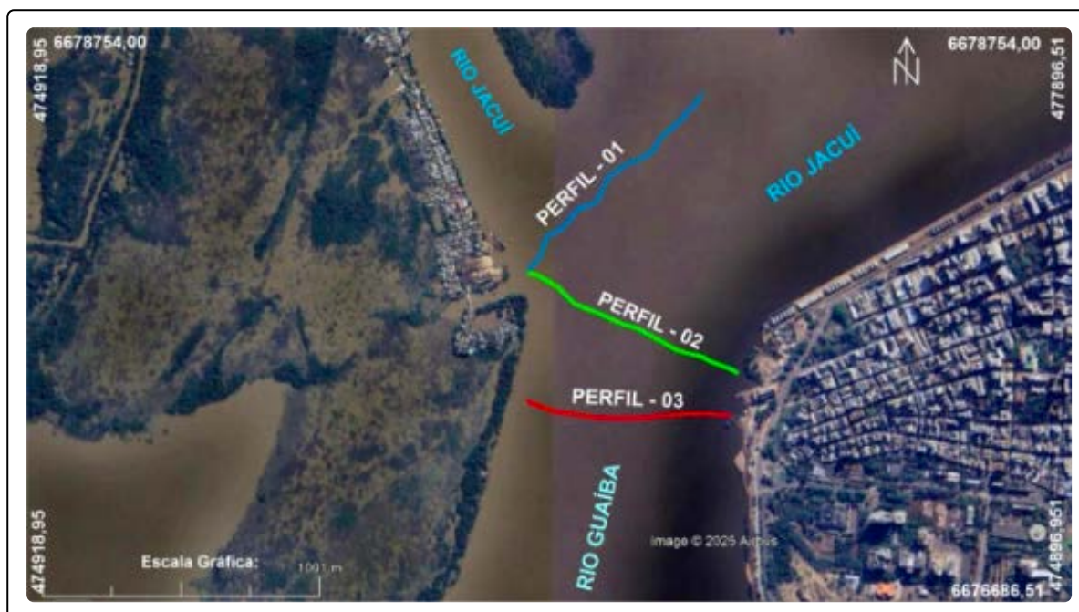
Figura 6. Localização dos três perfis batimétricos próximos à confluência dos rios Jacuí e Guaíba.
